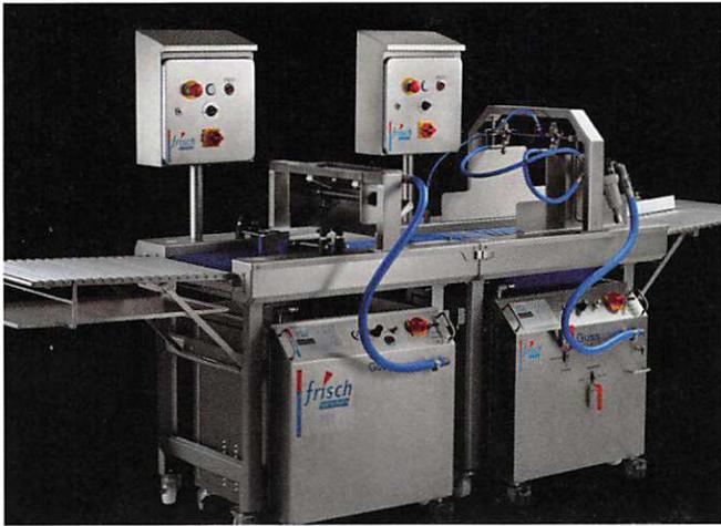
Combindo-Früchtelinie integriert werden kann. Bei einer Integration in eine Durchlauf-Bandanlage werden die Fruchtschnitten zu Beginn mit feinem Guss angesprüht und dann mit einem Schwall Tortenguss überzogen. Überflüssiges Material wird hierbei aufgefangen und dem Kreislauf wieder zugefügt, spezielle Abstreifer sorgen dafür, dass die Bleche auch an den Seiten sauber sind.
