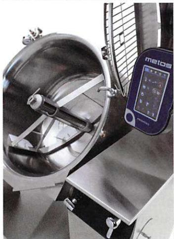
wird der Doppelmantel beim Kochen mit heißem Dampf (>120 °C) durchflutet, und beim Abkühlprozess mit kaltem Wasser. In beiden Fällen läuft der Prozess schneller ab als mit den Wärmeträgern. Die Maschinen sind in den Größen von 70–300 Liter (KORÜ-mat 2G) bez. 40–400 Liter (PROVENO 3G) lieferbar.
